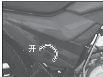
2. 使用梅花型螺丝刀拆卸7个空气滤清器外盖螺钉①，取下空气滤清器外盖②。
