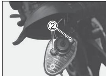
3. 压下灯泡向左旋转，拆下旧灯泡。安装新灯泡时，
