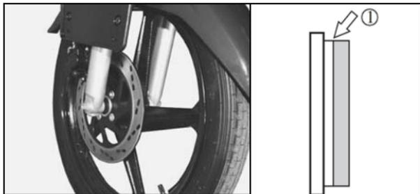
检查前刹车片的要领是检查该片是否磨损到限度线①，如果磨损超过此限度线，应更换新品。
